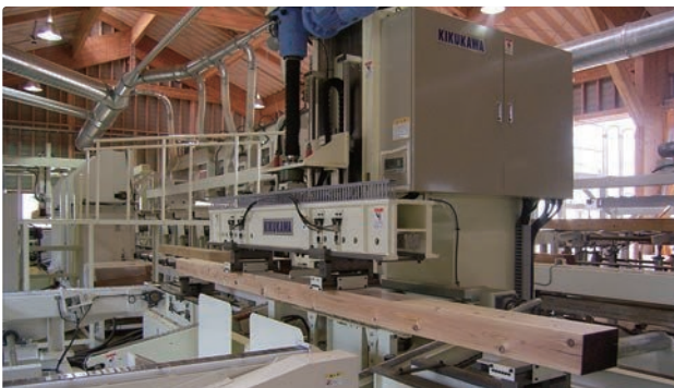
JAS(日本農林規格)で認められている測定機器を使用し、乾燥具合(含水率)や強度性能(ヤング係数)の測定を行っています。
