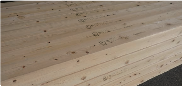
東濃桧の構造材は1本1本に性能表示 A材はSD-15 E-90以上を担保
