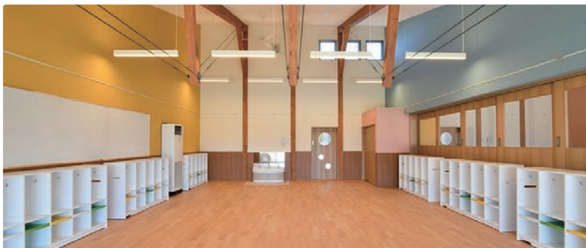
張弦トラス・タイバートラス・Aパネ（水平構面）／最大スパン10.92m
